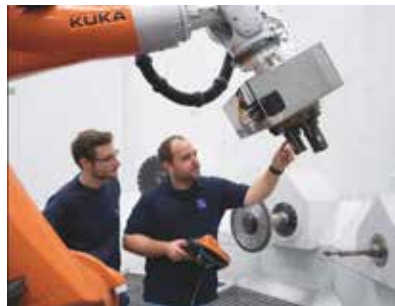
Christian Kunz (derecha) y Christian Haase inspeccionan las pinzas de un robot. Deben sostener fundiciones de motores pesados en las estaciones de procesamiento más adelante, que sobresalen de la pared a la derecha.
